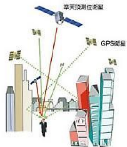
準天頂衛星「みちびき」の原理
